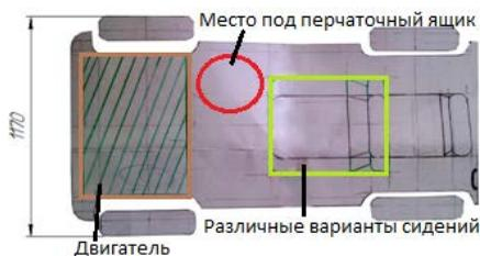
Рис. 10. Схема модульного автомобиля, вид сверху
