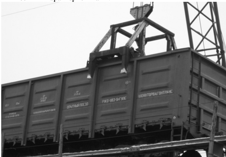
Рис. 2. Разгрузка полувагона модели 12-132 с использованием вибромашины ДП-32 УХЛ
