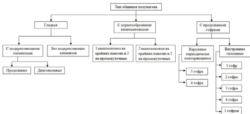
Рис. 4. Классификация обшивки кузовов полувагонов
