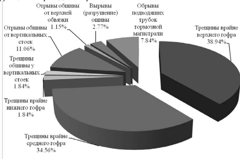
Рис. 3. Распределение неисправностей кузовов полувагонов, поступающих на пункты разгрузки с вибрационными машинами
