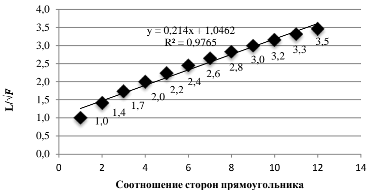
Рис. 4. Зависимость наибольшей протяженности территории от формы плана при прямоугольной планировке территории города
