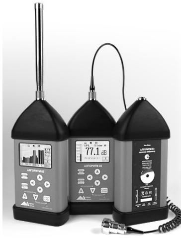
Рис. 5. Виброанализатор «Алгоритм 03»
