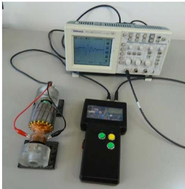
Рис. 2. Пример подключения мобильного устройства тестирования состояния изоляции якорных обмоток коллекторных машин методом волновых откликов
