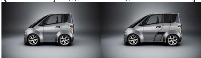
Рис.7. Идея раздвижного автомобиля Peugeot PLUX
