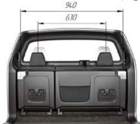
Рис. 4. Внутренние габариты автомобиля
