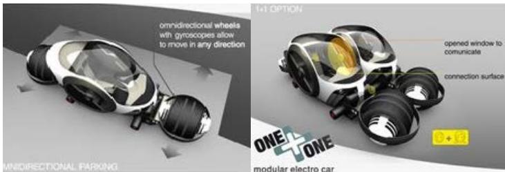
Рис.8. Модульный городской электромобиль *One+One*
