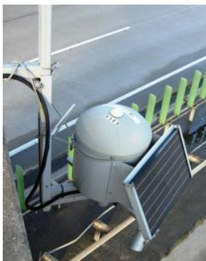
*Рис. 8. Датчик заторов на дороге в Германии*
